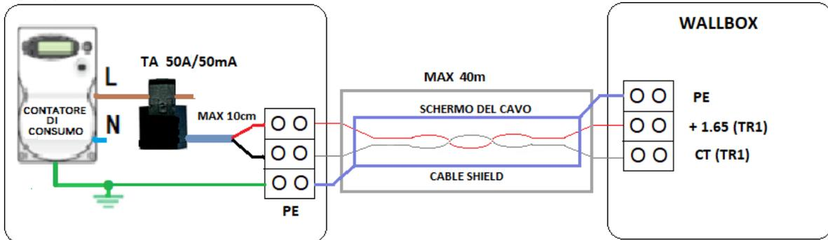
5. Per il collegamento del toroide (TA) utilizzare un cavo **schermato ethernet cat 5 ftp** anche per brevi distanze (maggiori di 10 cm) e usare solo una coppia twistata (quelle non utilizzate devono essere isolate); la lunghezza massima consigliata del cavo per un corretto funzionamento è 40mt (per distanze maggiori richiedere assistenza tecnica).
