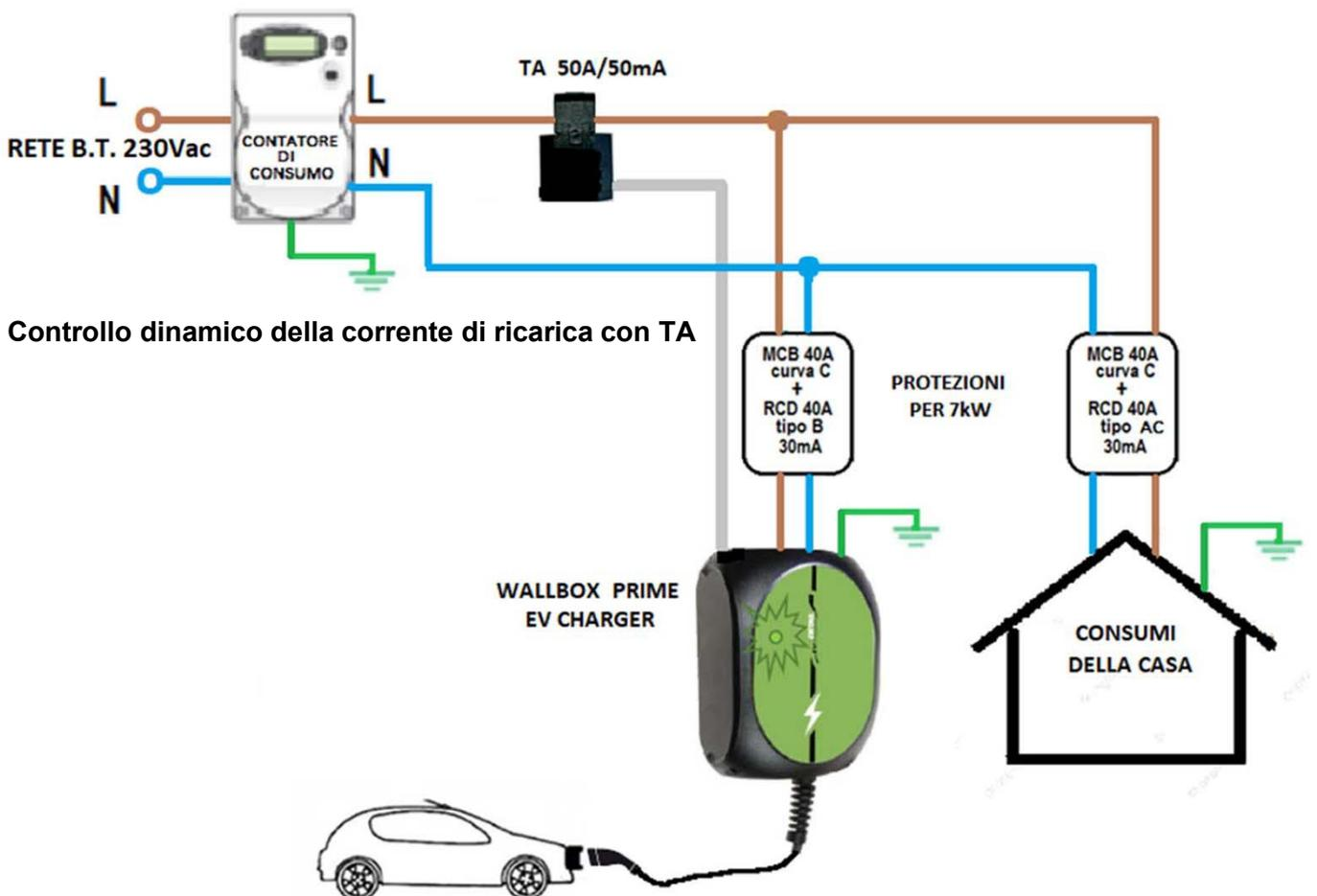
Il cavo di uscita del trasformatore amperometrico (TA) non è polarizzato .
